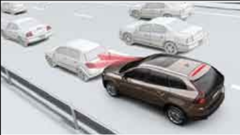
| City Safety. Según nuestras pruebas funciona a velocidades inferiores a los 30 km/h.
